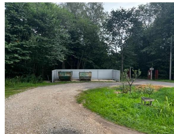
■ - контейнерная площадка 4000 x 10 500 м (установлена на дорожных плитах 3X1,75 x 0,17м; ограждение-профильный лист высотой 1,8 м)
